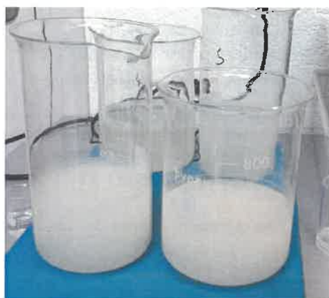
Figure 64 : Essais à la chaux réalisés sur 72 h pour tester l'élimination des sulfates
