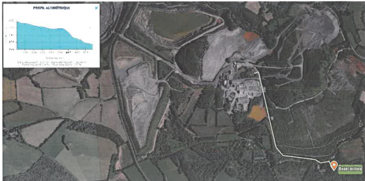
Figure 76 : Profil topographique du linéaire gravitaire de la filière de traitement vers le point de rejet au milieu naturel
